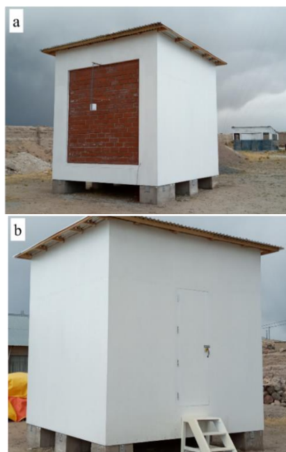
Fig. 1. Módulo experimental, (a) Pared de prueba y (b) posterior del módulo.
