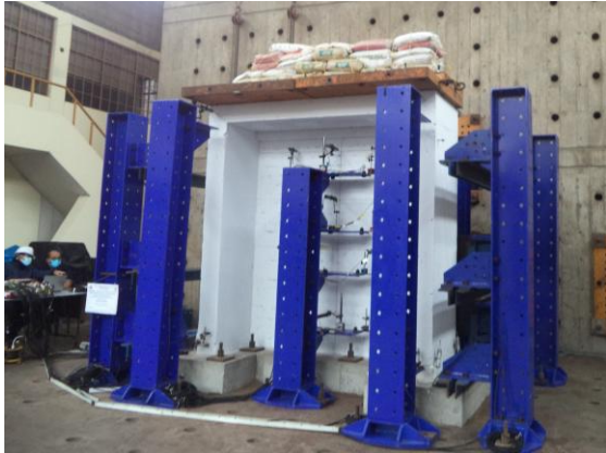
Fig. 2. Ensayo experimental ante cargas perpendiculares por tsunami
