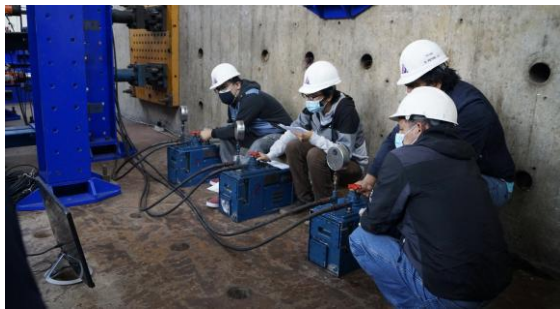
Fig. 10. Gatas Hidráulicas manuales para control por fuerza durante el ensayo
