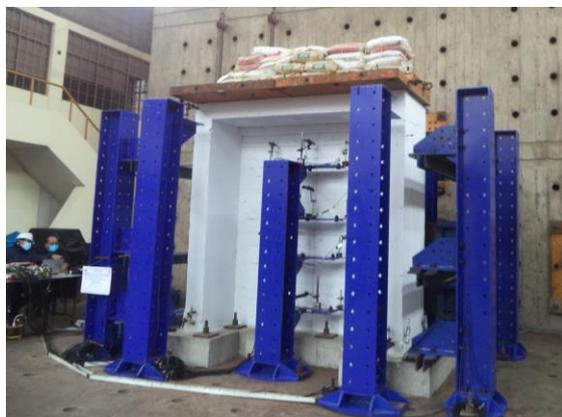
Fig. 2. Ensayo experimental ante cargas perpendiculares por tsunami
