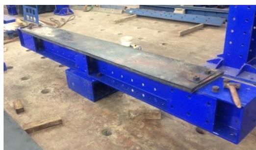
Fig. 8. Almohadilla de caucho para transmisión de la carga
