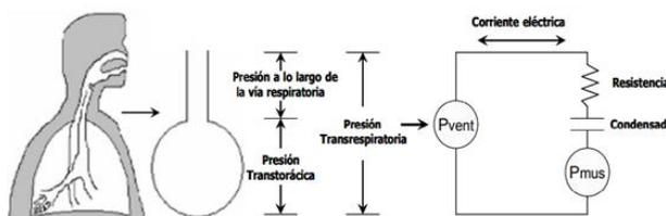
Fig. 1. Modelo del aparato respiratorio unicompartmental con su equivalente eléctrico. Adaptado de [31].
