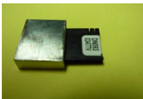
Fig. 2. El dosímetro Nanodot con su Build up de acero inoxidable de 2,0 mm equivalente a 15 mm de agua para un haz de fotones de 6 MV.
