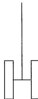
(b) Vista lateral del péndulo desde la izquierda de la figura (a), donde la cuerda está atada por medio de un lazo a la varilla horizontal, que conecta las dos placas “paralelas” que constituyen la parte masiva del péndulo.
