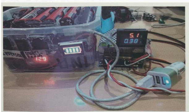
Figura 18. Batería de Li-ion de 12.6V y el cargador.
