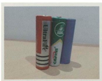
Figura 1. Celdas 18650 de iones de litio de 3.7v.
