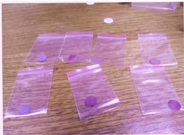
Figura 3: Electrodos cortados antes del armado de la batería.
