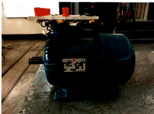
Figura 2. Motor eléctrico trifásico utilizado en el presente trabajo de investigación, en la figura se aprecia el tablero de conexión para los devanados.
