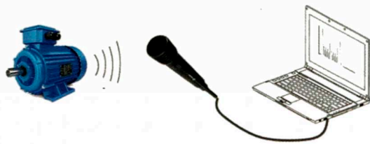
Figura 1. Sistema utilizado para obtener el ruido acústico del motor eléctrico.
