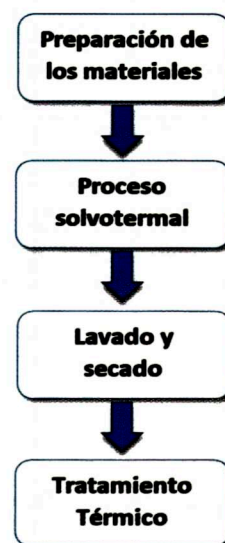
Figura 1: Esquema del proceso seguido en la síntesis y el tratamiento térmico de la nanopartícula \text{NaYF}_4 : \text{Yb}^{3+}, \text{Tm}^{3+} .
