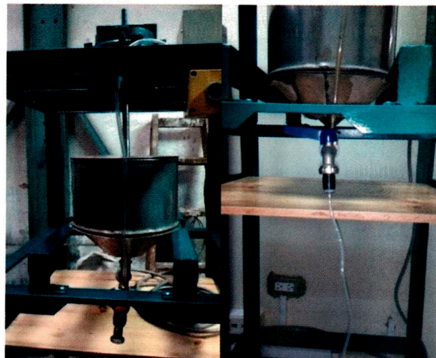
Figura 7. Prototipo de tanque (nueva cubeta) construido para la simulación experimental y computacional del sistema automatizado de mezcla y llenado del fantoma.
