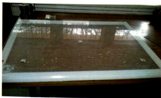
Figura 3. Ubicación de TLDs-100 encima de la cara superior del fantoma.
