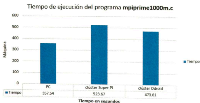
Figure 13. Ejecución del programa de cálculo de números primos hasta 1000 millones(mpiprime1000m.c) en diferentes máquinas(Menor tiempo es mejor performance).
