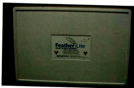
Figura 1. Co – 57 fuente de 10-15 mCi, nueva de 122 keV \gamma m y Vida media 270 días.
