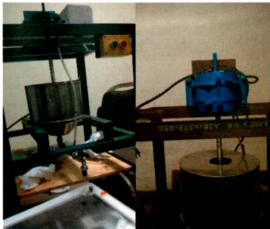
Figura 10. Mezclador diseñado y el motor de conexión externa
