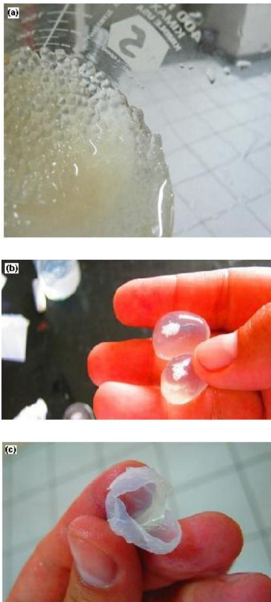
**Figura 5.** Fotos de cápsulas quitosano-alginato: (a) Cápsulas de 6 – 7 mm; (b) Cápsulas de 2 – 3 cm; (c) Cápsula de 2 – 3 cm abierta, mostrando su centro hueco.
