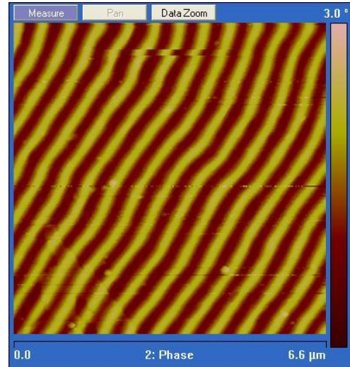
Figura 18. Microscopía de Fuerza Magnética de la película de 250\text{ nm} .
