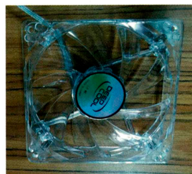
Figure 4. Ventilador usado en el clúster.
