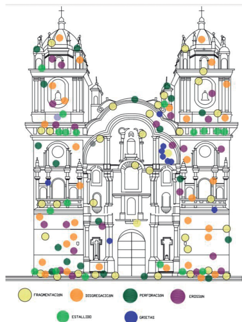
Figura 10. Cartografía de diagnóstico de patologías en la Iglesia de la Compañía de Jesús. Elaboración propia, 2019.
