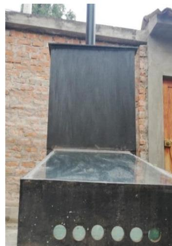
Fig. 13. Secador solar Indirecto-Pasivo.
