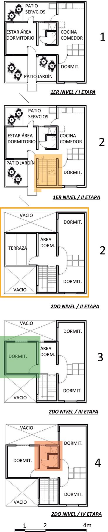
Figura 6. Progresión de la vivienda Previ-PP2. Elaborada con datos del informe final del equipo técnico del Previ (Galvez, 1972a).
